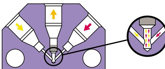
THE TWO SOLVENT STREAMS ARE WELL-MIXED IN THE VORTEX MIXING CHAMBER
